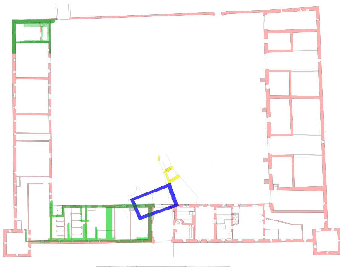
004. Plattegrond van de bouwhoeve, zoals deze door A. Mulder is opgemeten. In twee tinten groen zijn de door de TH Delft vrijgegraven muren weergegeven. In blauw en geel zijn de funderingen van oudere (van vóór 1650) gebouwen aangegeven. Op deze tekening ontbreken de opmetingsgegevens van RAAP.
